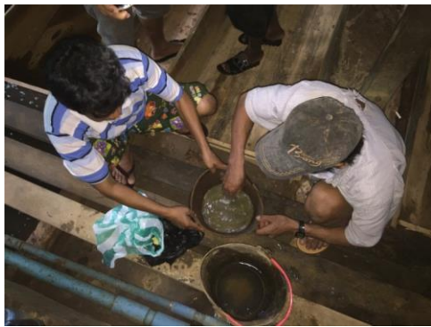
သစ်သားမြောင်းထဲတွင် သန့်စင်သတ္တုရိုင်းများမှ ဆာလဖိတ်ခြပ်ပေါင်းများဖယ်ထုတ်နေပုံ
