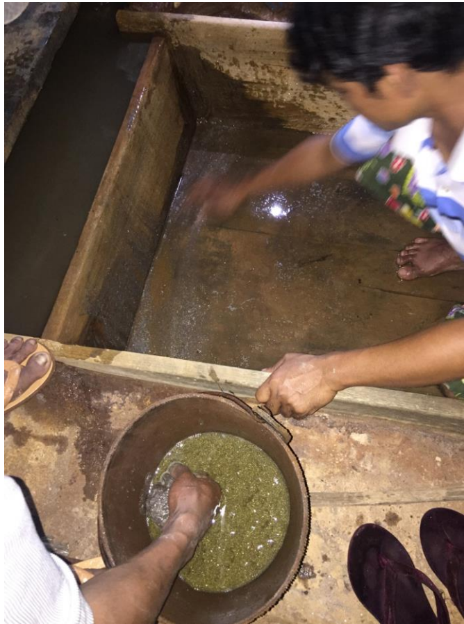
သန့်စင်ကန်အတွင်းသို့စီးဆင်းသည့်မြောင်းအတွင်းဓာတုပစ္စည်းများရောစပ်နေပုံ
