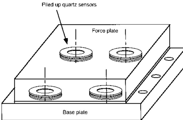
Fig. 5.11 A piezoelectric tool dynamometer
