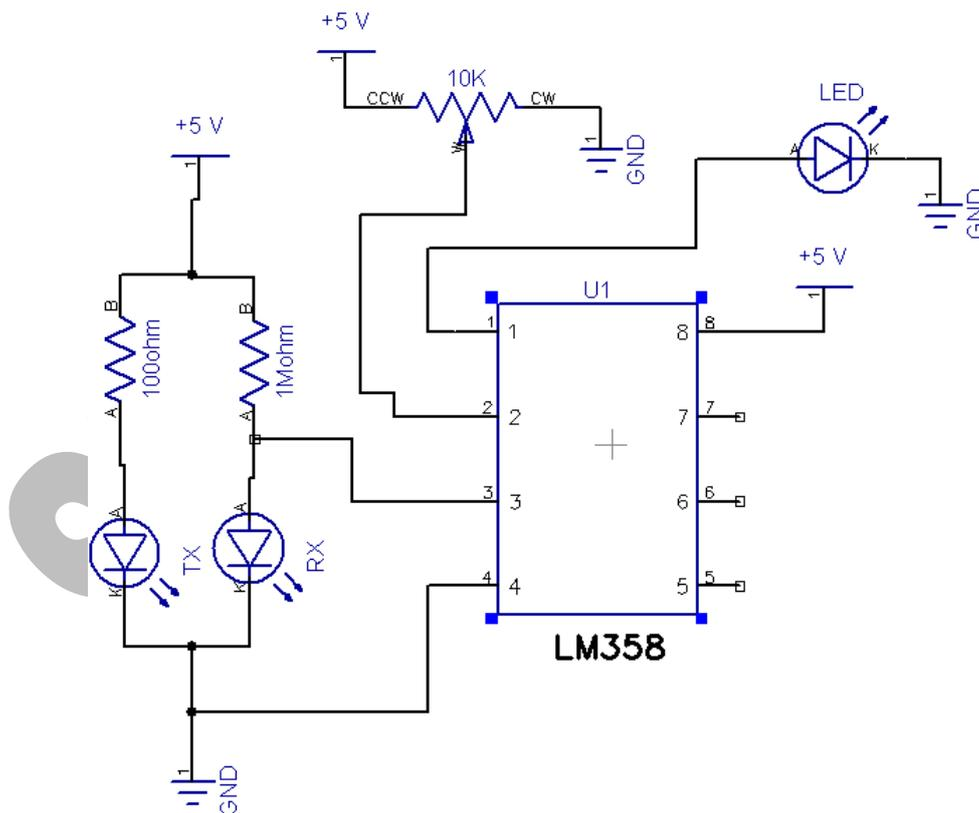
Fig: IR SENSOR MODULE CIRCUIT
