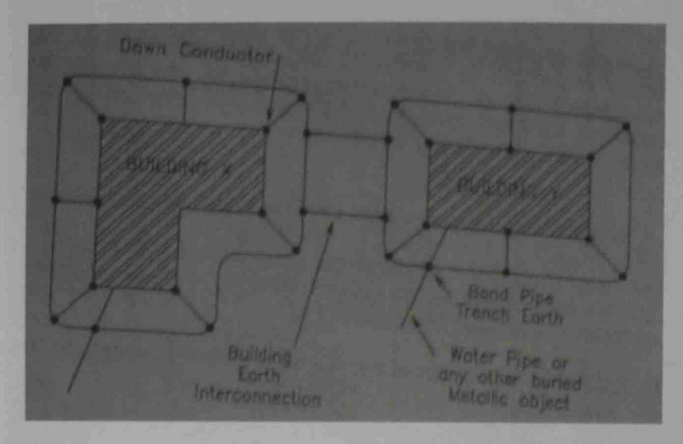
Step 4: Define Bonding Bars for equipotential Bonding:
