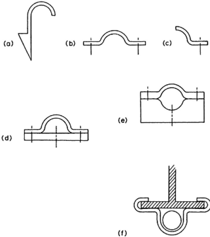
*Figure 3.10* Conduit fixings
