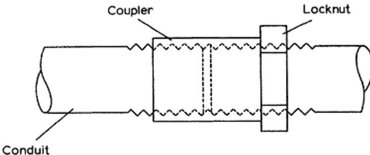
*Figure 3.1* Conduit coupling
