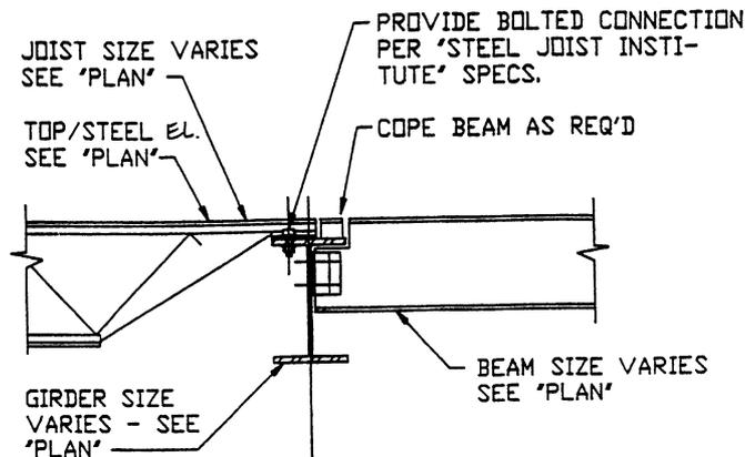
**BAR JOIST AND BEAM CONNECTION
