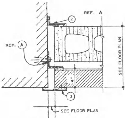
**B EXPANSION JOINT CONNECTION AT EXTERIOR WALL**
